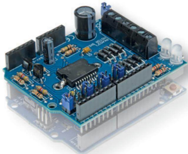
**Consente di pilotare: relé, solenoidi, motori passo-passo e motori DC.**
