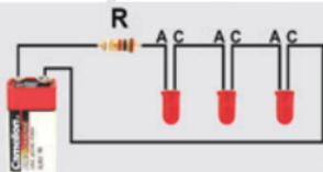
$$\frac{\text{Alimentazione (V) - (numero di LED x tensione LED (V))}}{\text{corrente richiesta (A)}} = \text{resistenza in serie (ohm)}$$
