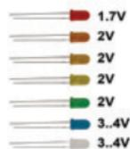
I LED presentano una caduta di tensione specifica, in funzione del tipo e del colore. Controllare la scheda tecnica per conoscere l'esatto valore di tensione e la corrente nominale!
