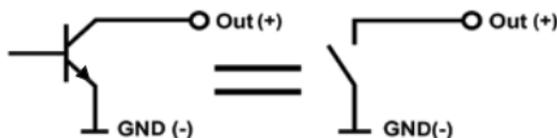
Esempio: come controllare un LED mediante un'uscita open collector
