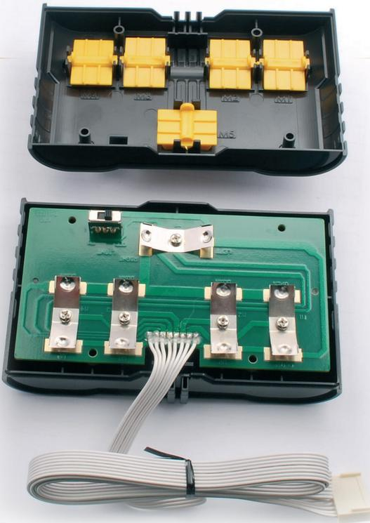
**Fig. 4 -** Scatola dei comandi aperta: alla base si trova il circuito stampato che contiene i contatti fissi; quelli mobili sono in una busta a parte e vanno avvitati in modo da sovrapporsi, ma senza toccare le piazzole.
