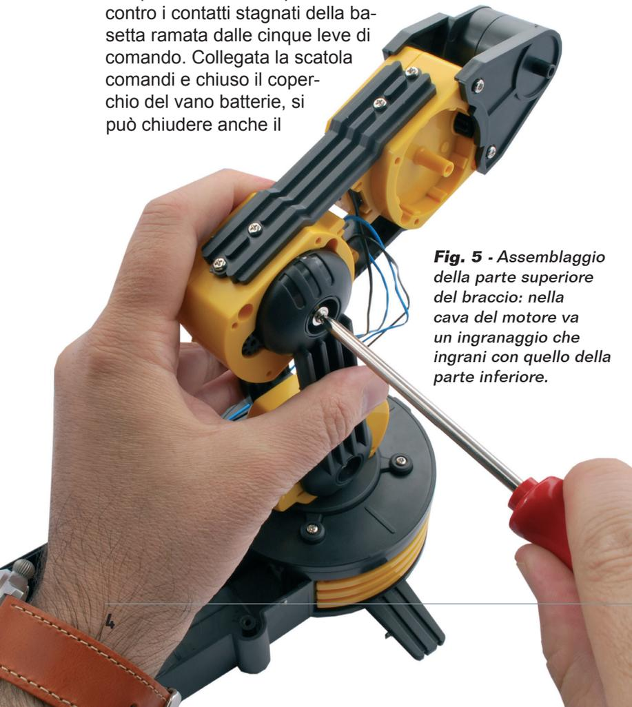
**Fig. 5 -** Assemblaggio della parte superiore del braccio: nella cava del motore va un ingranaggio che ingrani con quello della parte inferiore.
