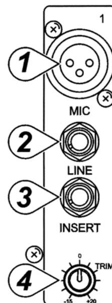
cablaggio: Tip = positivo (+), Ring = negativo (-), Sleeve = massa.
