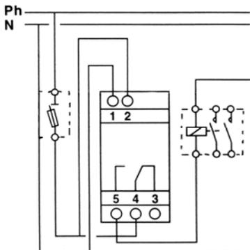
contatto normalmente chiuso), o ai terminali 4 e 5 (per il controllo tramite il contatto normalmente aperto). Stringere adeguatamente le viti dei morsetti per assicurare un buon contatto. Evitare di chiudere nel morsetto anche la parte isolante del cavo.
