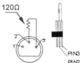
Se il cavo di collegamento DMX è molto lungo o è sottoposto ad interferenze elettromagnetiche, si raccomanda di utilizzare una terminazione che permette di preservare il segnale digitale di controllo da rumori di natura elettrica. La terminazione non è altro che un connettore XLR con collegato al suo interno (tra i pin 2 e 3) una resistenza da 120 ohm, e deve essere applicata al connettore XLR d'uscita dell'ultimo dispositivo della catena. Fare riferimento al disegno riportato a fianco.
