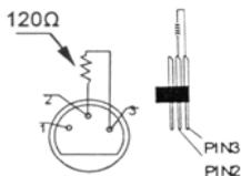
Se il cavo di collegamento DMX è molto lungo o è sottoposto ad interferenze elettromagnetiche, si raccomanda di utilizzare una terminazione che permette di preservare il segnale digitale di controllo da rumori di natura elettrica. La terminazione non è altro che un connettore XLR con collegato al suo interno (tra i pin 2 e 3) una resistenza da 120 ohm, e deve essere applicata al connettore XLR d'uscita dell'ultimo dispositivo della catena. Fare riferimento al disegno riportato a fianco.
