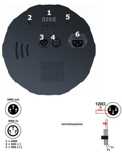
Come trasformare la linea di controllo da 3-pin a 5-pin (spina e presa).
