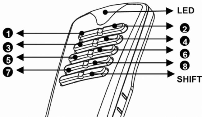
I canali 1 .. 8 possono essere configurati per funzionare in modo "bistabile" (ON / OFF) o "impulsivo" (vedere set-up).
