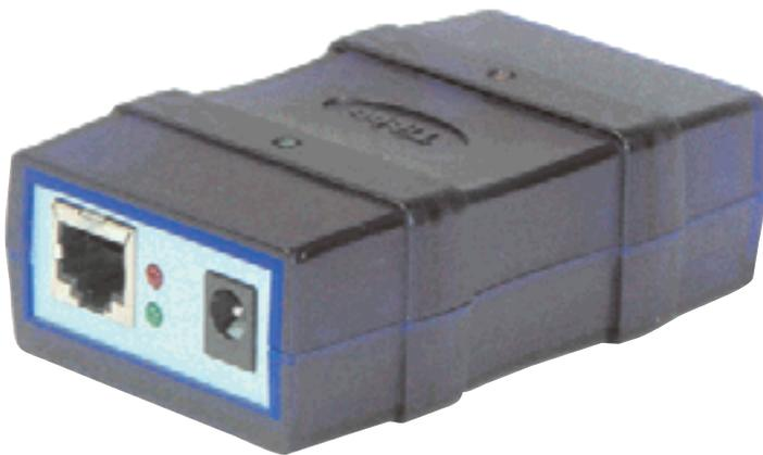
**Il Tibbo DS100 è un Server di Periferiche Seriali, consente cioè di collegare un dispositivo munito di porta seriale ad una LAN Ethernet, permettendo quindi l'accesso a tutti i PC della rete locale o da Internet senza dover modificare il software esistente. Dispone di un indirizzo IP ed è in grado di comunicare attraverso UDP e TCP. Supporta inoltre i protocolli ARP e ICMP.**
