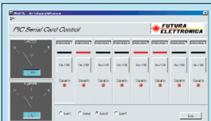
Una videata del software WinPIC, utilizzato per controllare l'interfaccia a relè. Si noti la selezione della porta COM3. Nonostante il PC disponga di due sole porte seriali, la COM3 viene simulata dal driver ed il software è in grado di funzionare senza alcun problema.
