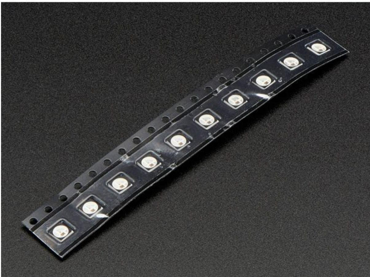
Confezione contenente 10 Mini LED (3,5x3,5 mm) a tecnologia NEOPIXEL con chip WS2811. È possibile collegare molti di questi LED in cascata, utilizzando solo 1 pin di controllo, per realizzare strip, matrici, ecc. Può essere controllato anche con Arduino, Fishino o altro microcontrollore.
