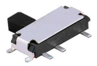
Confezione contenente 10pz Micro deviatori a levetta per circuito stampato montaggio SMD. È in grado di attivare carichi con assorbimento massimo di 50 mA a 12 VDC, vita operativa media: 100.000 commutazioni, tipo di contatto: SPDT, temperatura di lavoro: da -25°C a +85°C. Dimensioni corpo (mm): 7,8x2,7x1,4.
