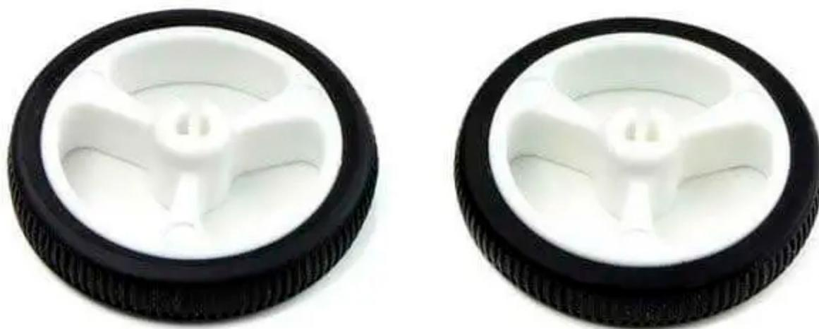
Confezione contenente una coppia di ruote in plastica bianche con pneumatico. Diametro esterno ruota (con pneumatico): 32 mm, larghezza del pneumatico 6,5 mm. Progettate per essere inserite con facilità sull'alberino a "D" da 3 mm dei micro motoriduttori in metallo della serie MMGxxx. Peso:
