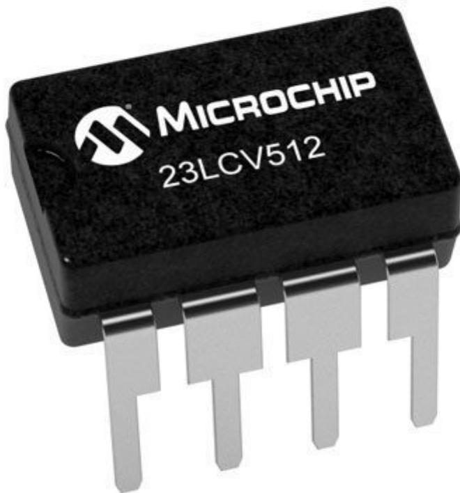
Memoria SRAM seriale SPI da 512 Kbit con supporto per batteria di backup esterna e interfaccia SDI (Serial Dual Interface). La memoria è accessibile tramite un semplice bus seriale compatibile SPI (Serial Peripheral Interface). Supporta anche letture e scritture illimitate sull'array di memoria e supporta il backup dei dati tramite batteria esterna a bottone collegata a VBAT (pin 7). Case PDIP 8 pin.
