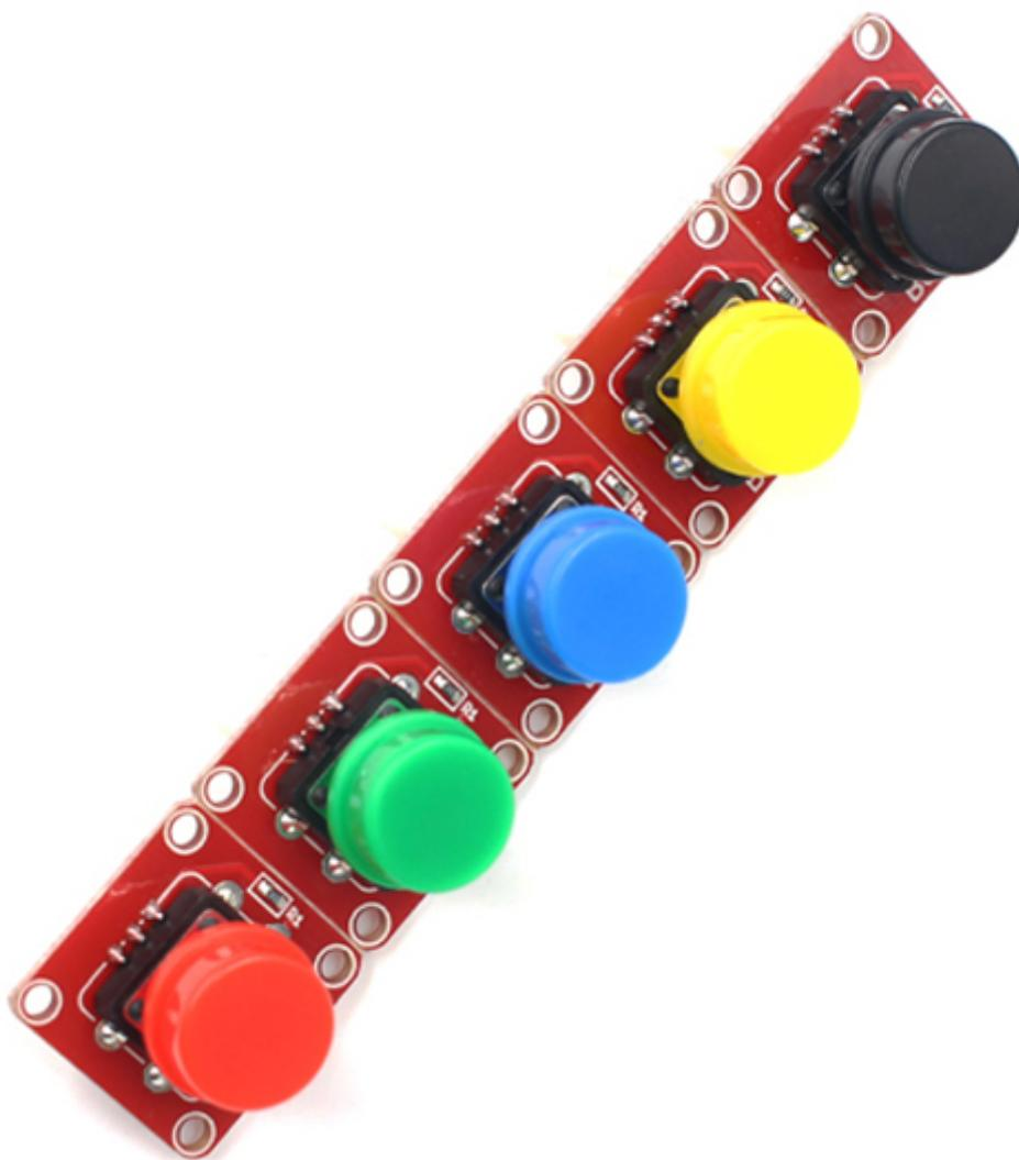
Set composto da 5 modulini con pulsante colorato e 5 cavetti lunghi 20 cm con connettore a 3 pin passo 2 mm. Alimentazione: da 3 a 5,5 volt. Premendo il pulsante si ottiene un livello logico alto e quando viene rilasciato va basso. Particolarmente indicati per applicazioni con Arduino, Fishino, ecc. Dimensioni modulino (mm): 20,1x20,1x22 (altezza).
