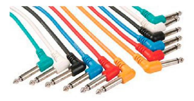
Confezione contenente 6 cavi colorati (nero, giallo, bianco, rosso, verde, blu) dotato di jack mono da 6,35 mm a 90°. Lunghezza: 1 metro, conduttore interno: 0,12 mm x 20, calza: 0,12 mm x 64, diametro esterno: 5 mm.
