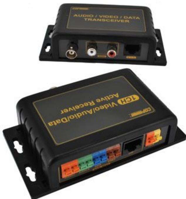
Consente di inviare (tramite cavo UTP) a distanza un segnale sia audio che video. Portata massima di 1200 metri con segnale video a colori e bianco/nero. Dispone di filtro che impedisce interferenze da disturbi esterni. Possibilità di integrare sensori (PIR, magnetici, ecc) e dati (controllo Pan, Tilt e Zoom per telecamere).
