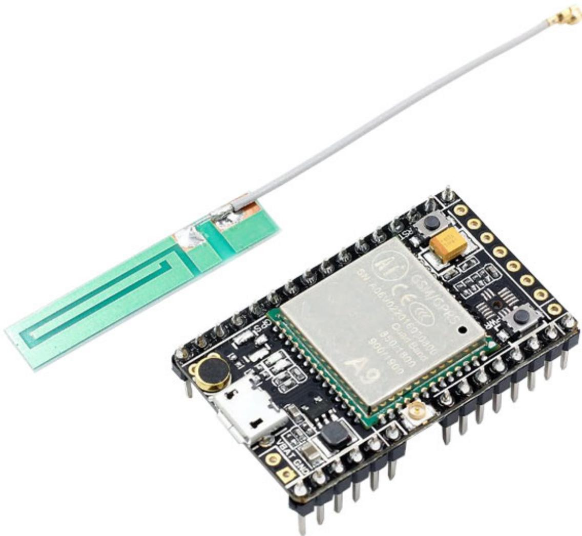
Breakout board basata sul modulo Quad-band GSM/GPRS Ai-Thinker A9. Può essere controllato con comandi AT, ma anche programmato grazie Ai-Thinker SDK. Dispone di 29 GPIO, slot per micro SIM Card e micro SD Card, pulsante di reset e power, microfono, pin per il collegamento di un altoparlante (SPKN-SPKP), connettore micro USB per alimentazione e comunicazione PC, ingresso per batteria Lipo da 3,3 – 4,2 volt (pin VBAT), due LED per applicazioni utente.
