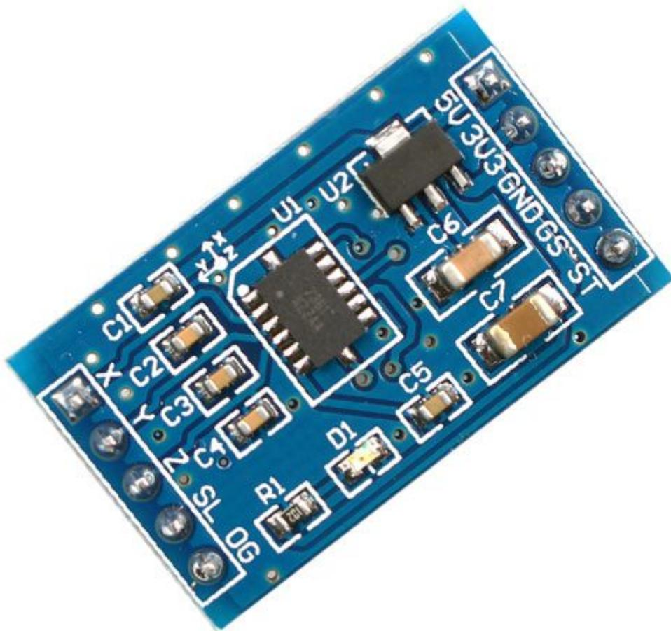
Accelerometro analogico a 3 assi basato sul chip MMA7361L della Freescale. Range di misura 1,5 e 6g (selezionabile), elevata sensibilità: 800 mV/g a 1,5g, alimentazione: da 3,3 a 5 VDC, consumo: 400  $\mu$ A. Dispone di modalità sleep con un consumo di 3  $\mu$ A, condizionamento del segnale con filtro passa-basso, compensazione della temperatura, self test e 0g-detect. La scheda viene fornita già montata e collaudata.
