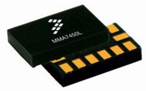
Accelerometro a tre assi dalle dimensioni estremamente ridotte (appena 3mm x 5mm x 1mm) realizzato dalla Freescale. Dispone di un bus SPI e I2C. L'uscita digitale migliora la comunicazione con il micro ed elimina l'esigenza di un convertitore analogico-digitale dedicato.
