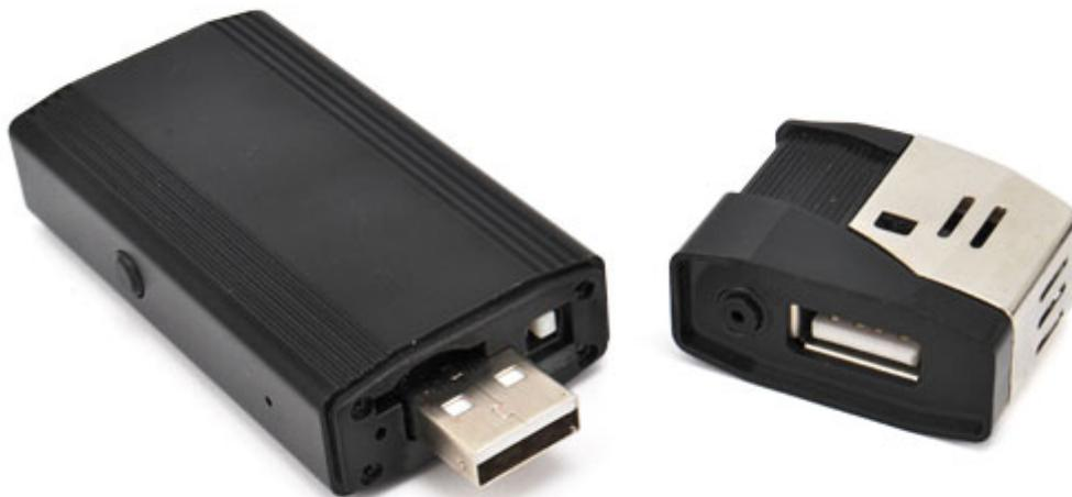
Nascoste in questo accendino, realmente funzionante, si trovano una micro telecamera CMOS a colori con obiettivo pinhole, un mini DVR su micro SD card (non compresa), un microfono, una luce a LED e una batteria ricaricabile ai polimeri di litio da 300 mAh. Oltre al normale funzionamento come accendino è possibile effettuare registrazioni audio e video. La confezione include: l'accendino con telecamera nascosta e DVR, cavo USB e manuale (in inglese).
