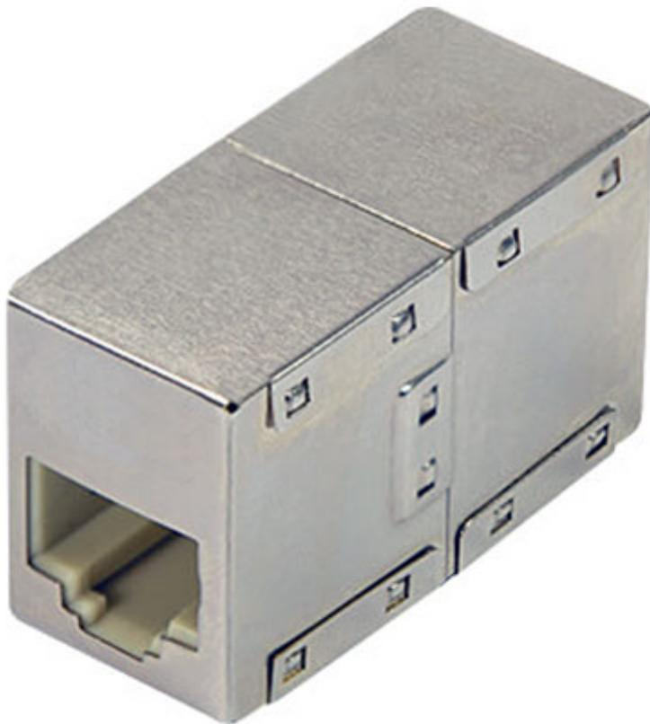
Questo accoppiatore metallico, dotato di due connettori RJ45 (8P8C) CAT 5e femmina-femmina, permette di collegare insieme due cavi RJ45 come se fosse un unico cavo. Dispone di schermatura metallica per una trasmissione ottimale di segnali fino a 100 MHz. Le prese RJ45 sono adatte ai cavi CAT 5e. Dimensioni (mm): 38x23x18.
