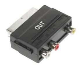
Adattatore 3 RCA femmina (out) / SCART maschio (in) . Permette di prelevare il segnale audio/video da un VCR, da un DVD, ecc, dotato di presa scart e di inviarlo ad un TV che dispone di ingressi RCA audio/video.
