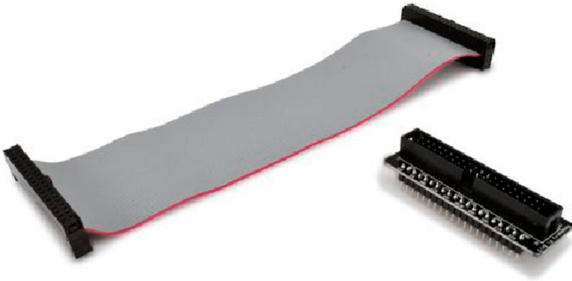
Dotato di pin strip passo 2,54 mm e di connettore maschio a 40 pin, consente di collegare mediante flat cable (incluso nel kit) una board Raspberry Pi tipo B+, Raspberry Pi 2 o Raspberry Pi 3 ad una comune breadboard sulla quale è stata realizzata la propria applicazione. La confezione comprende: PCB codice 7200-S1216, 1 connettore maschio 2x20 pin per cavo flat, 1 connettore strip M/M 40 poli tornito, cavo flat 2 connettori F/F 2x20 pin. Dimensioni (mm): 63,70x20,60x19,50.
