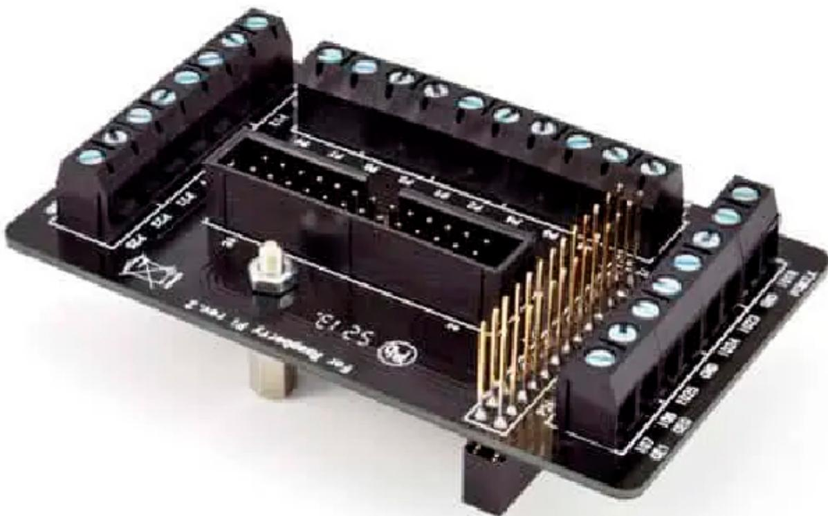
Scheda dotata di morsettieria a 26 poli, pin strip M/F a passo 2,54 mm e connettore maschio a 26 pin. Questa board consente di portare su morsetto tutte le linee I/O presenti sul connettore della board Raspberry Pi rev.2 (modello B). Tramite questa shield è anche possibile collegare mediante flat cable (incluso nel kit) la board Raspberry Pi ad una comune breadboard sulla quale è stata realizzata la propria applicazione (utilizzando necessariamente l'adattatore FT1072K, non incluso).
