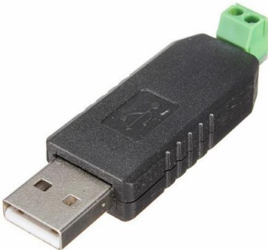
Adattatore con convertitore USB-RS485, dispone di connettore USB tipo B da un lato e morsettiera 2 poli dall'altro (D+ :A, D- :B). Non necessita di alimentazione esterna ma quest'ultima viene prelevata direttamente dalla porta USB. Compatibile con gli standard USB 2.0 e USB 1.1
