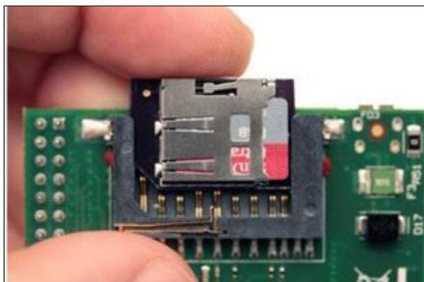
Adattatore a basso profilo da micro SD card a SD card. Particolarmente indicato per essere inserito direttamente nello slot di raspberry Pi, evita di utilizzare le SD card formato full che sporgono dal PCB rischiando di danneggiarsi.
