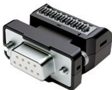
Adattatore da connettore DB9 femmina (con il lato più largo verso il basso) a morsettiera senza viti per dispositivi TIBBO dotati di interfaccia DB9 maschio. Particolarmente utile quando viene utilizzato in sistemi RS422 o RS485 dove generalmente è necessario collegare direttamente i cavi dati. Particolarmente indicato per essere utilizzato con i controller DS1102 e DS100B.
