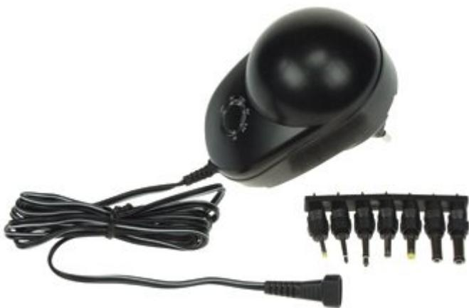
Adattatore di rete universale in grado di fornire una corrente massima in uscita pari a 500 mA. Dispone di commutatore rotativo che consente di selezionare una delle 6 tensioni d'uscita disponibili: 3 - 4.5 - 6 - 7.5 - 9 - 12 Vdc. Dotato di LED luminoso che indica la tensione d'uscita selezionata. Dispone di protezione da corto circuiti, da surriscaldamento e da sovraccarichi. Completo di 7 plug intercambiabili.
