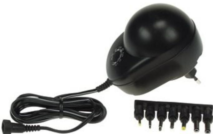
Adattatore di rete universale in grado di fornire una corrente massima in uscita pari a 800 mA. Dispone di commutatore rotativo che consente di selezionare una delle 6 tensioni d'uscita disponibili: 3 - 4.5 - 6 - 7.5 - 9 - 12 Vdc. Dotato di LED luminoso che indica la tensione d'uscita selezionata. Dispone di protezione da corto circuiti, da surriscaldamento e da sovraccarichi. Completo di 7 plug intercambiabili.
