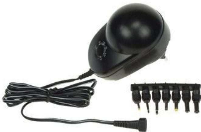
Adattatore di rete universale stabilizzato in grado di fornire una corrente massima in uscita pari a 500 mA. Dispone di commutatore rotativo che consente di selezionare una delle 7 tensioni d'uscita disponibili: 1.5, 3 - 4.5 - 6 - 7.5 - 9 - 12 Vdc. Dotato di LED luminoso che indica la tensione d'uscita selezionata. Dispone di protezione da corto circuiti, da surriscaldamento e da sovraccarichi. Completo di 7 plug intercambiabili.
