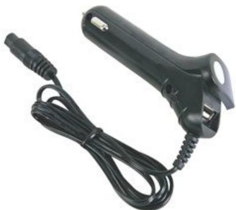
Piccolo e leggero alimentatore dotato di plug accendisigari per auto con tensione d'uscita a 5 Vdc. Dispone di protezione da sovraccarico, corto-circuito, doppia uscita e indicatore LED di alimentazione. Viene fornito di 3 plug (Ø4.0x10.0mm) d'uscita intercambiabili in modo da essere adattato alle proprie esigenze.
