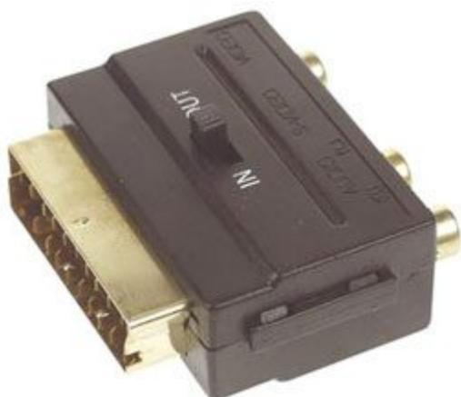
Adattatore SCART maschio / 3 x RCA femmina con deviatore (INPUT/OUTPUT) per selezionare la direzione del segnale audio/video. L'adattatore ha i contatti della spina SCART e delle prese RCA dorati.
