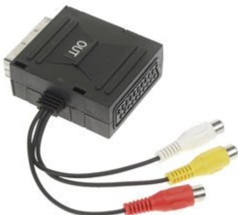
Permette di inviare ad un TV, mediante gli ingressi RCA, un segnale audio/video prelevato da una telecamera, un VCR o un DVD etc, senza che sia necessario staccare il cavo SCART pre-esistente.
