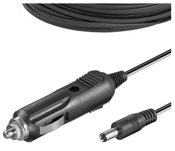
Cavetto con spinotto per presa accendisigari e connettore spina DC (5,50 x 2,10 mm). Cavo con anima in rame, diametro esterno 2,5 mm, lunghezza 1,8 metri. Fusibile interno di protezione da 2,5A.
