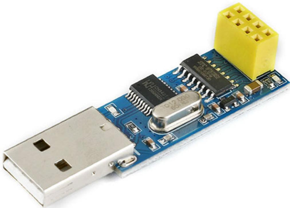
Questo adattatore USB per NRF24L01+ è progettato per consentirti di controllare facilmente più dispositivi di comunicazione NRF24L01 dal tuo PC. Puoi utilizzarlo come telecomando, per la trasmissione di dati, o come sistema VOIP, tra le altre possibilità. Il modulo utilizza il chip CH340T come convertitore USB a TTL. **Il modulo NRF24L01+ non è incluso e deve essere acquistato separatamente, vedi prodotti correlati.** L'adattatore è compatibile con Windows 7, 8, 10 e 11 a 32 bit e 64 bit.
