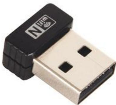
Micro adattatore da USB a LAN wireless, dotato di LED indicatore dello stato di collegamento, velocità di trasferimento dati fino a 150Mbps (downlink) e 150Mbps (uplink), portata 100 m all'interno e fino a 300 m in spazi aperti (senza ostacoli). Requisiti di sistema: porta USB 2.0. libera, sistema operativo: Windows 7/Vista/XP/2000 o Linux 2.4 o superiore, lettore CD/DVD. Dimensioni (mm): lunghezza 19,25 x spessore 8,67.
