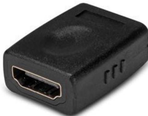
Adattatore da connettore HDMI (femmina) a connettore HDMI (femmina). Supporta 3D, audio HD, 1080P. Banda passante segnale: 340 MHz, banda passante canale TMDS (Transition Minimized Differential Signaling): 10,2 Gbit/s, Audio Return Channel (ARC), profondità di colore: 48 bit/px. Applicazioni: dispositivo A: DVD, PC, ricevitore - dispositivo B: LCD, plasma, proiettore, TFT. Dimensioni (mm): 29x21x11, peso: 10 grammi.
