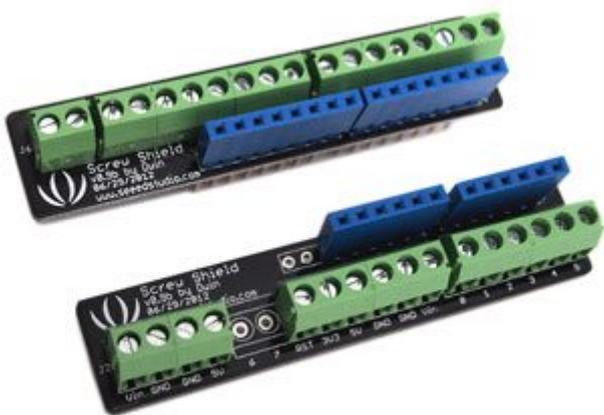
Composta da due schede, una con 18 terminali e una con 16, rende disponibili i pin di Arduino su comode morsettiere a vite. Ideali per Arduino duemilanove, possono essere utilizzati anche su Arduino UNO (in questo caso i pin aggiunti su questa versione, SDA e SCL vicino al pin AREF e i due nuovi pin vicino al pin di reset, non sono disponibili sulla morsettiera). La confezione comprende anche un connettore per l'interfaccia SPI.
