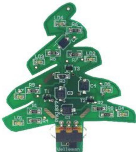
Albero di Natale in miniatura con 7 LED che si illuminano in sequenza creando un piacevole effetto luminoso. Alimentazione tramite batteria CR2032 (non inclusa) o mini-USB (5V). Dimensioni 63x57mm. Il kit SMD perfetto per le vacanze Natalizie! Facile da montare, è l'ideale introduzione alla tecnologia SMD.
