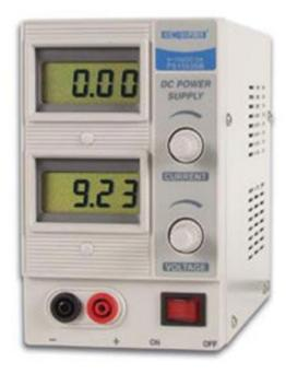
Alimentatore stabilizzato da laboratorio con uscita singola di 0-15 VDC e corrente massima di 3A. Limitazione di corrente da 0 a 3 A impostabile con continuità. Due display LCD con retroilluminazione indicano la tensione e la corrente erogata dall'alimentatore. Contenitore in acciaio, pannello frontale in plastica. Colore: bianco/grigio.
