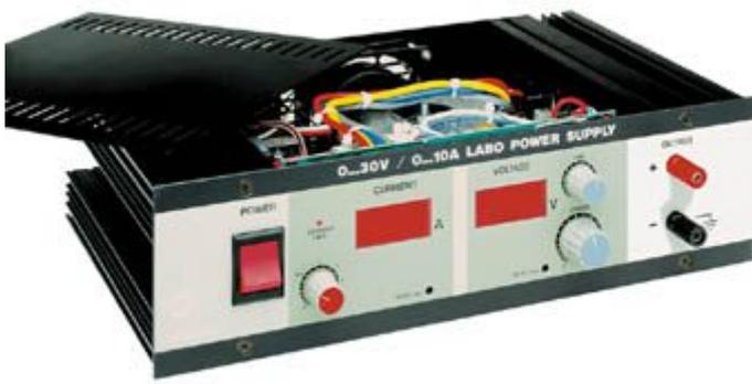
Un alimentatore stabilizzato è, senza dubbio, uno strumento prezioso in ogni laboratorio, sia esso professionale che hobbistico. Dotato di voltmetro e amperometro digitale, questo alimentatore, grazie al ventilatore interno, è in grado di assicurare un funzionamento a pieno carico per lunghi periodi di tempo. Fornito completo di contenitore, manopole, trasformatori e display digitale.
