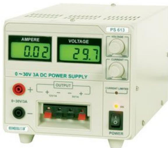
Alimentatore stabilizzato da laboratorio con due tensioni di uscita fisse (5V/1A e 12V/1A) e una tensione regolabile da 0 a 30 V con corrente di uscita massima di 2,5A. Protezione da cortocircuiti e da sovraccarico. Amperometro e voltmetro con display LCD. Contenitore in acciaio galvanizzato.
