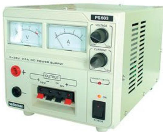
Alimentatore stabilizzato da laboratorio con due tensioni di uscita fisse (5V/1A e 12V/1A) e una tensione regolabile da 0 a 30 V con corrente di uscita massima di 2,5A. Protezione da cortocircuiti e da sovraccarico. Amperometro e voltmetro di tipo analogico. Contenitore in acciaio galvanizzato.
