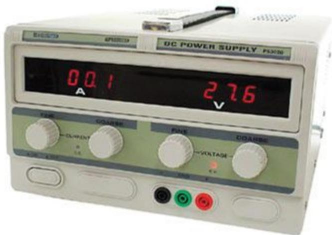
Alimentatore stabilizzato da laboratorio con uscita singola di 0-30 Vdc e corrente massima di 20 A. Limitazione di corrente da 0 a 20 A impostabile con continuità. Due display indicano la tensione e la corrente erogata dall'alimentatore. Contenitore in acciaio, pannello frontale in plastica. Colore: bianco/grigio.
