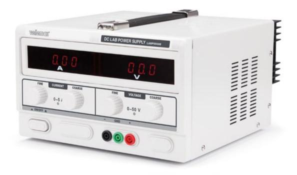
Alimentatore lineare da laboratorio con tensione di uscita regolabile da 0 a 50 Vdc e corrente massima di 5 A. Dispone di doppio display a LED per visualizzare la tensione e la corrente, regolazioni di tensione e corrente normale e fine. Modalità di protezione: limitazione di corrente, connettori di uscita: IEC1010, protezione di rete: fusibile. Colore: bianco-grigio.
