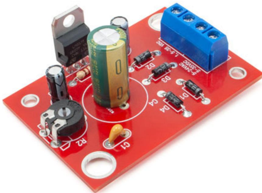
Questo piccolo alimentatore fornisce una tensione di uscita stabilizzata regolabile tra 1,5 e 35 V con una corrente di 1 A. Il regolatore LM317 presenta caratteristiche di ronzio residuo e di regolazione straordinariamente migliori rispetto ai regolatori convenzionali. I circuiti di limitazione della corrente e di protezione termica sono inclusi nel chip. Fornito senza dissipatore.
