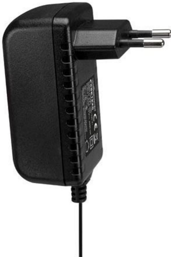
Alimentatore switching ultra compatto con uscita stabilizzata a 12 V - 2 A plug DC (positivo centrale). Protetto da cortocircuito e sovraccarico, dispone di basso ripple e rumore, alta efficienza e basso consumo di energia in assenza di carico.
