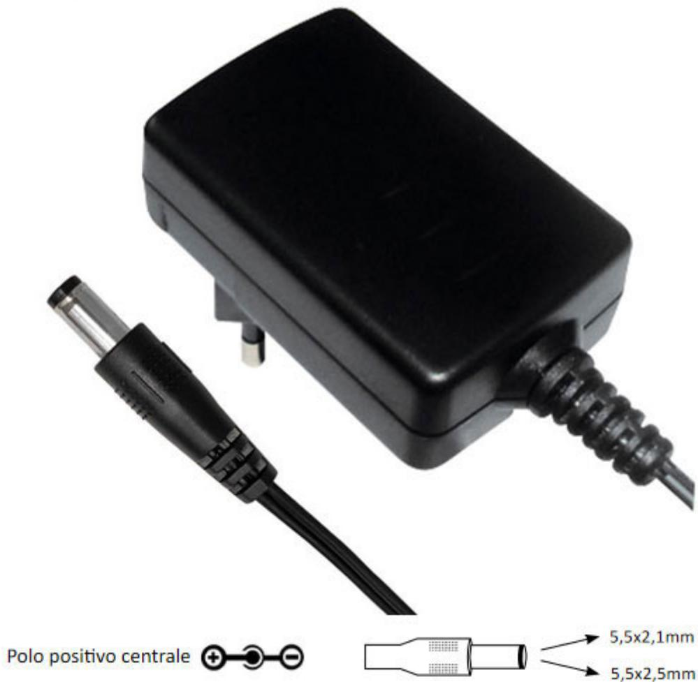
Alimentatore switching ultra compatto con uscita stabilizzata a 12 V - 2 A e spinotto d'uscita a baionetta (adatto sia per connettori 5.5x2.1 mm che per connettori 5.5x2.5 mm). Protetto da cortocircuito, sovraccarico e sovratensione, dispone di basso ripple e rumore, alta efficienza e basso consumo di energia in assenza di carico.
