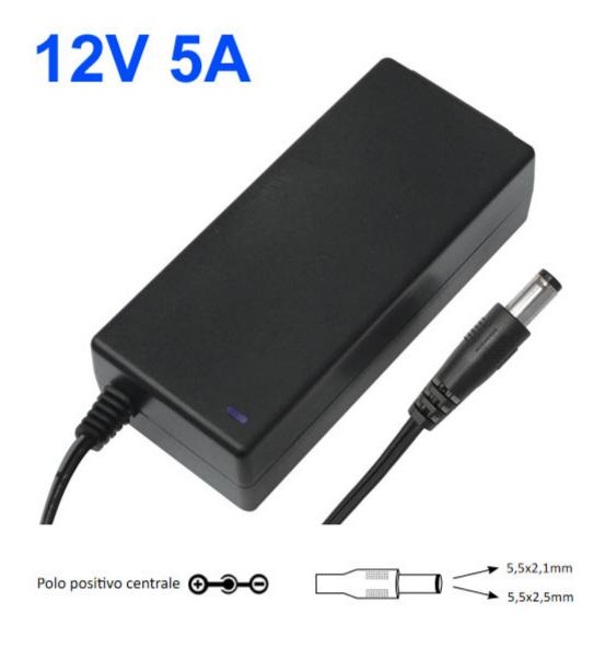
Alimentatore switching ultra compatto con uscita stabilizzata a 12 V - 5 A e spinotto d'uscita a baionetta (adatto sia per connettori 5.5x2.1 mm che per connettori 5.5x2.5 mm). Protetto da cortocircuito e sovraccarico, dispone di basso ripple e rumore, alta efficienza e basso consumo di energia in assenza di carico.
